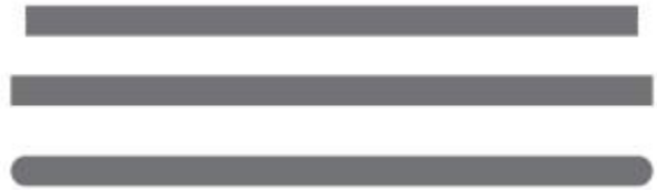
Linienenden (von links nach rechts): Quadratische Kappe, erweiterte quadratische Kappe und runde Kappe.
