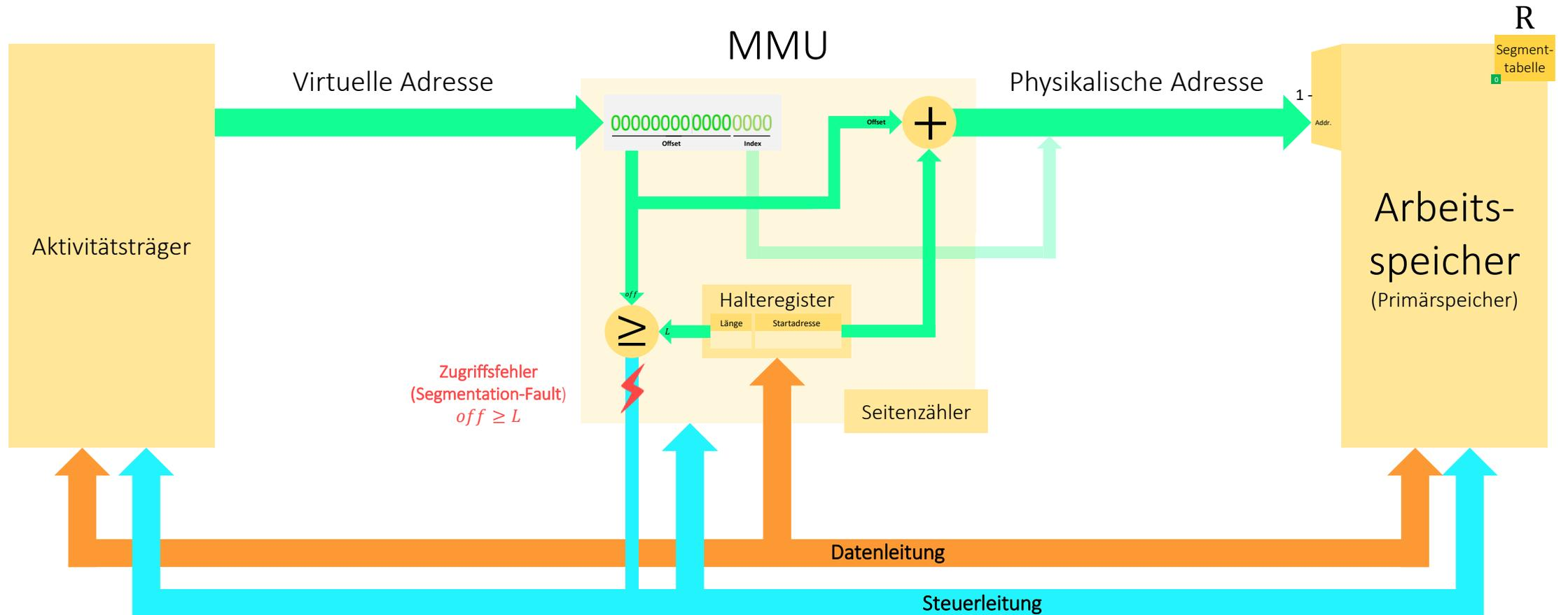
Setzt man  $\overrightarrow{\text{Index}} = \vec{0}$ , führt die MMU eine Identitätsabbildung aus: So kann direkt auf Segmenttabelle **R** zugegriffen werden.
